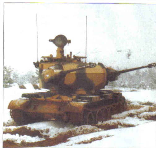
Jedna z nejkurióznějších variant T-55. Na korbě tanku T-55 je protiletadlová věž Marksman se dvěma protiletadlovými automatickými kanony ráže 35 mm. Podobné úpravy jsou nabízeny na prodej do arabských států.
