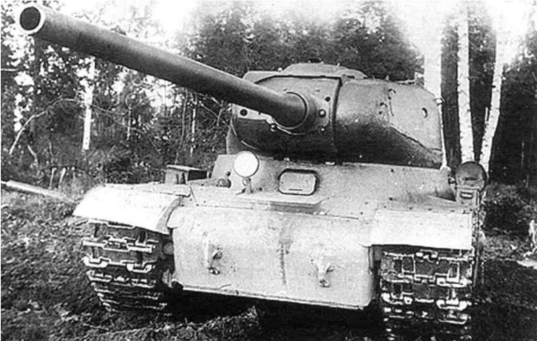
Neúspěšný prototyp Objekt 248 s kanonem S-34 ráže 100 mm
