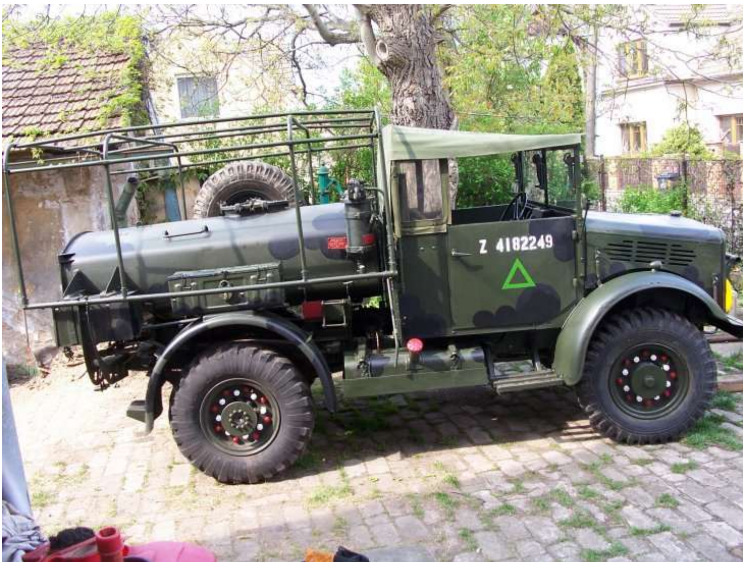
MWC Přes trubkový rám se dala napnout plachta a tím maskovat cisternu jako běžný valník
