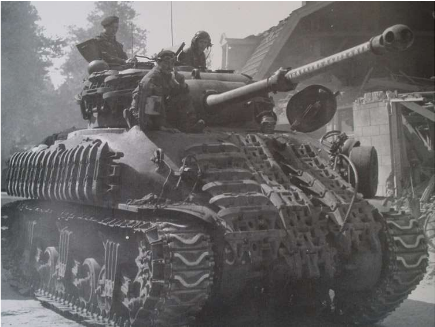
Sherman IC Hybrid ze svazku Kanadské 5. Obrněné divize. Stroj je opatřen přídavným pancéřováním z článků tankového pásu a také je dobře viditelná kamufláž „dlouhé“ sedmnáctiliberky
